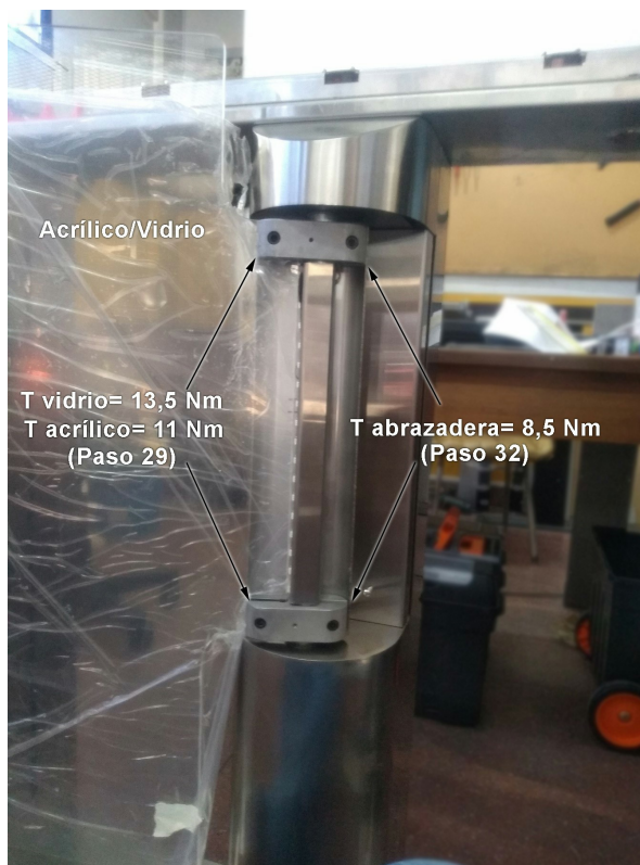
Figura 6. Colocar vidrio/acrílico de Puerta. Esta figura presenta información relacionada con los pasos 28, 29 y 32 del presente manual.
