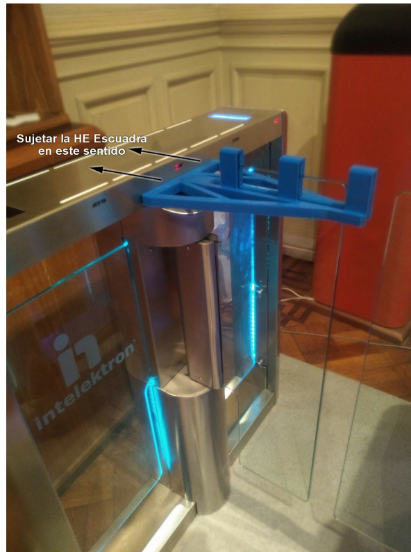
Figura 8. Centrar mecánicamente vidrio de Puerta.
